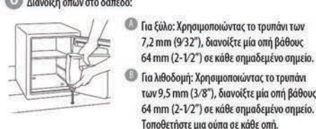
7 Τοποθετήστε το χρηματοκιβώτιο στην επιθυμητή θέση, με τις οπές του χρηματοκιβωτίου ευθυγραμμισμένες με τις οπές στο δάπεδο.
